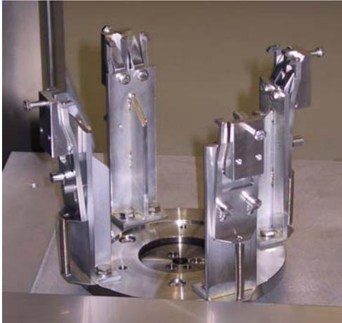
Abbildung 11: Iris Heft- und Schweißvorrichtung für innen liegende Schweißlage
