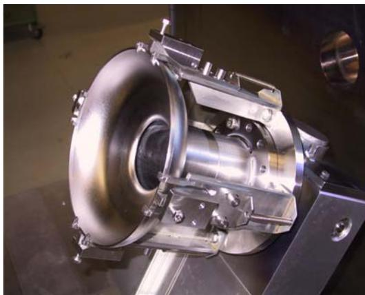
Abbildung 12: Schweißvorrichtung mit eingebauter Halbzelle und Strahlrohr unter 45°
