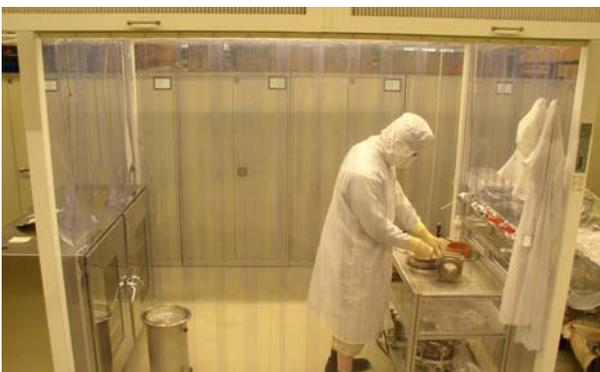
Abbildung 10: Lokaler Reinraum mit Montageplatz, Vakuumtransportbehälter und N<sub>2</sub> Lagerschrank
