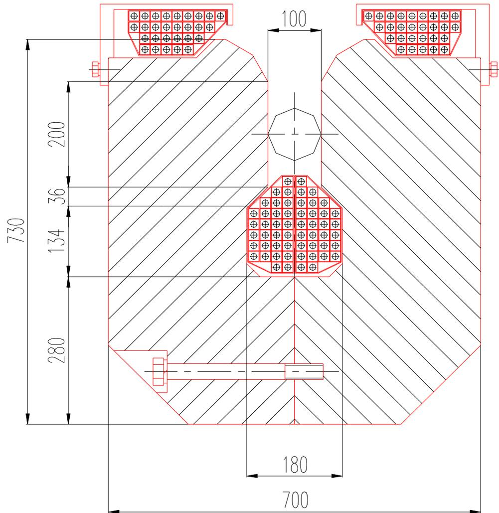
Fig. II. 3 The cross-section of BENDV1 - BENDH3 - BENDH4 magnets
