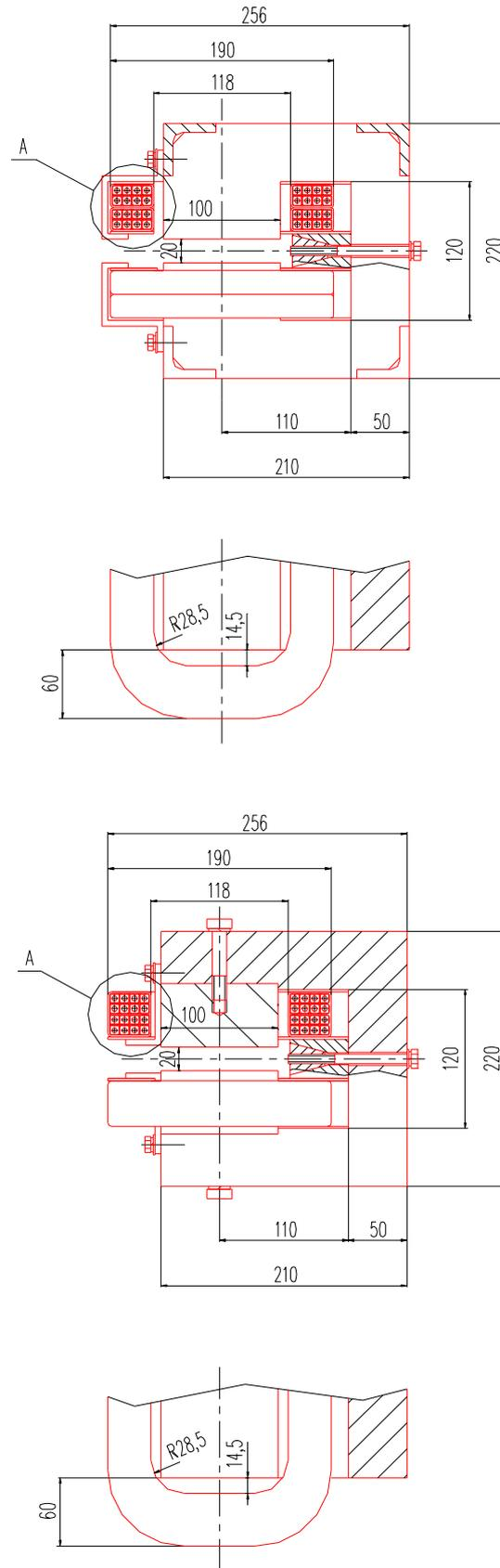
Fig. II. 2 The cross section of BENDH1 - BENDH2 magnets
