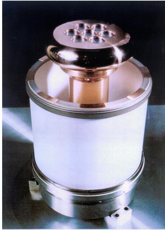
Figure 3.4.1: *Cathode of the multibeam klystron.*
