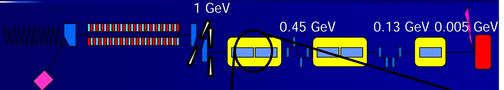
6 Kryomodule mit je 8 Cavities
